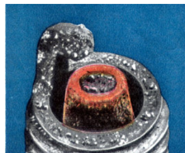
е - свеча, поврежденная ранним зажиганием
